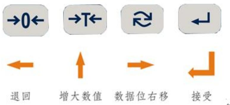
进入设置模式后，功能键具有导航和数据输入的双重作用。当需要进行设定或选择时，功能键的作用如下图所示。
