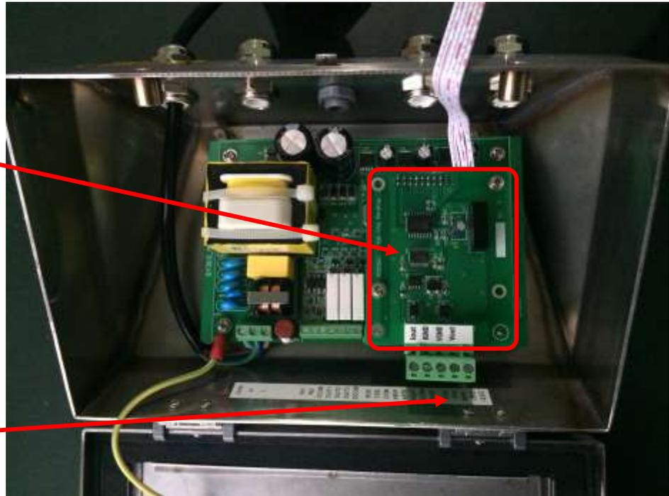
2、按接线排定义将传感器接入右侧的传感器接口
