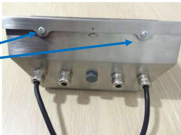
1、如果安装了模拟量接口板（如图所示），拆下上层的模拟量接口板的 2 个螺丝，向上轻轻拔出模拟量接口
